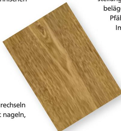
**Einsatzbereiche:** Das Holz der Robinie wird zur Herstellung von Furnieren, Möbeln, Sperrholz, Bodenbelägen, Werkzeuggriffen sowie beständigen Pfählen, Pfosten, Palisaden und Masten genutzt. Im Außenbereich lässt es sich für den Schiffs- und Brückenbau sowie für Spielplätze und Gartenmöbel verwenden. Auch die Gewinnung von Zellstoff und Energieholz – häufig aus Kurzumtriebsplantagen – ist wirtschaftlich interessant.
