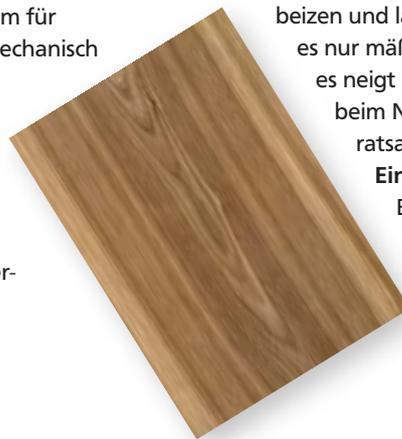
**Verarbeitbarkeit:** Das Holz lässt sich leicht verkleben, beizen und lackieren. Aufgrund der Härte ist es nur mäßig gut zu sägen, hobeln, dreheln, es neigt beim Trocknen zum Reißen und Werfen, beim Nageln und Schrauben ist vorbohren ratsam.
