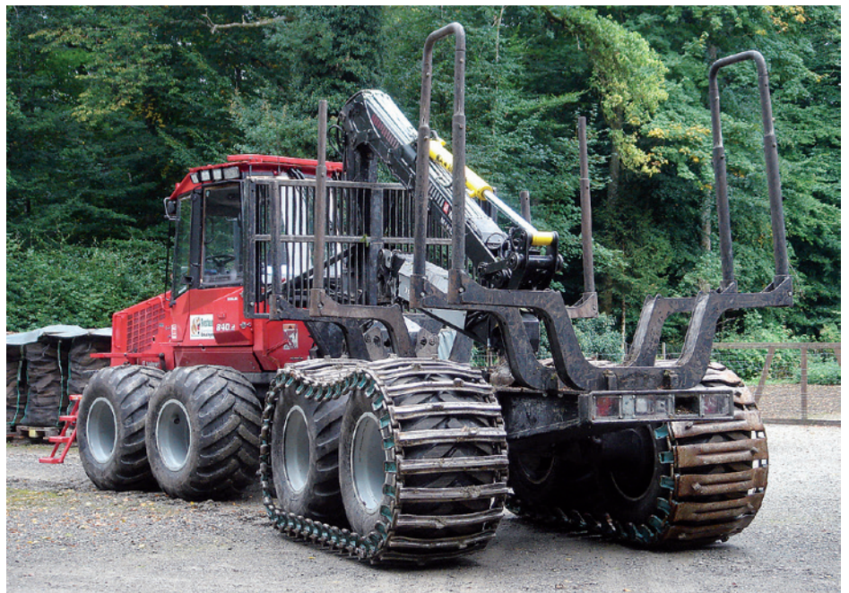
Abb. 13. Der Forwarder wurde zu Demonstrationszwecken mit zwei verschiedenen Arten von Bogiebändern ausgerüstet: links Traktionsbänder zur Verbesserung der Steigfähigkeit und der Sicherheit am Hang, rechts tragende Bänder zur schonenderen Befahrung schlecht tragfähiger Böden in ebenem und leicht geneigtem Gelände.
